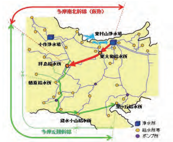
多摩地域の送水管ネットワーク
